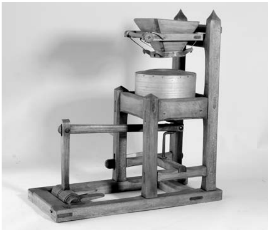
Obr. 7: Dřevěný model mlýna na mletí obilí na nožní pohon. Inv. č. E 9278. Foto Gabriela Skyva Dobešová, fotoarchiv MJVM.
