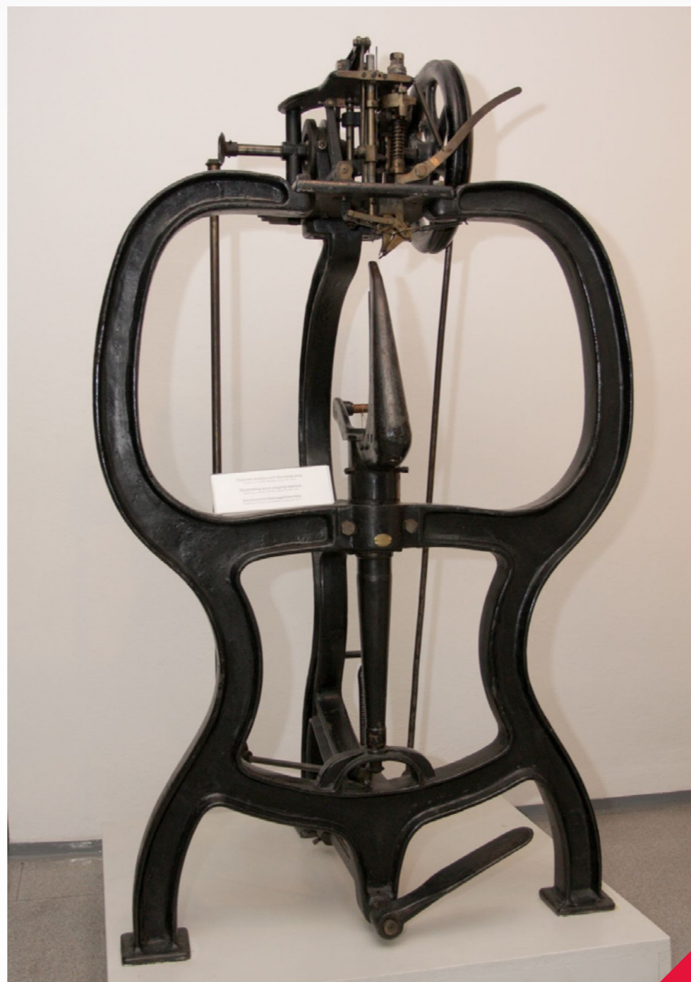
Obuvnický stroj na prošívání podešví typu Mc Key z roku 1900, vývojový typ podle patentu Lymana Reeda Blaka. Sbírka Muzea jihovýchodní Moravy.
